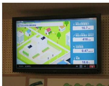
発電モニター
