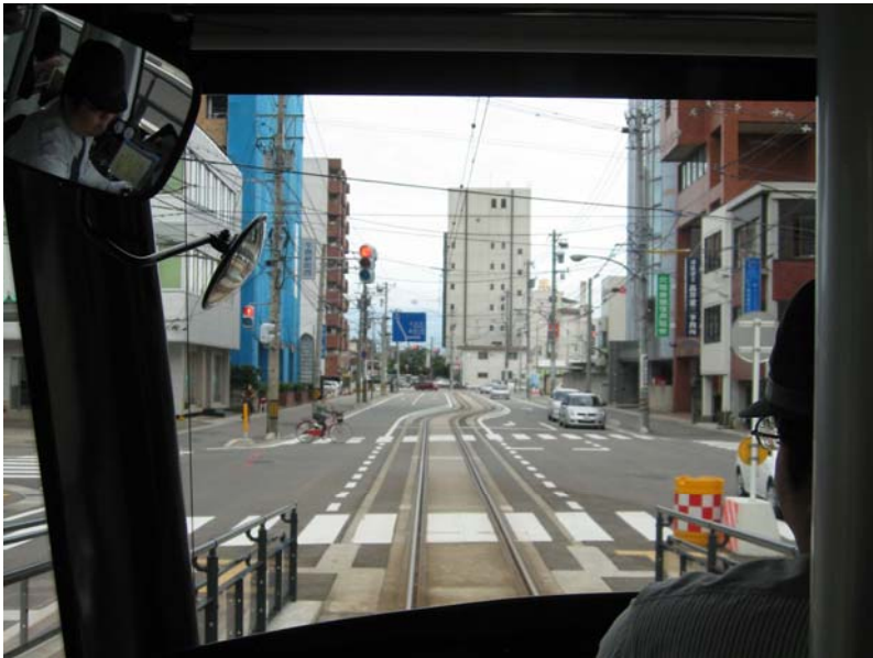
奥田中学校前電停までの区間は一般の道路に軌道が敷かれている併用区間となっている。
