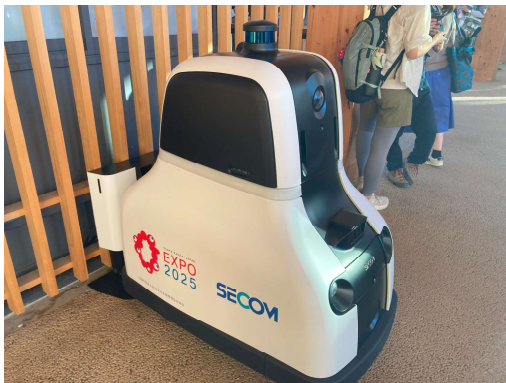
写真：巡回しながらカメラでとらえた映 像を AI 解析し、ルート上に転倒者 や障害物を検知した場合は防災セ ンターに通報する警備ロボット
