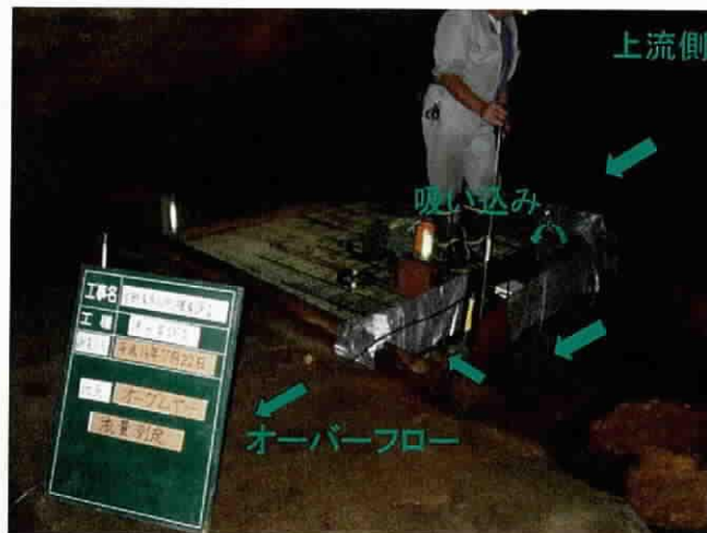
図 2-11 フルチンガー水位・水量測定状況写真
