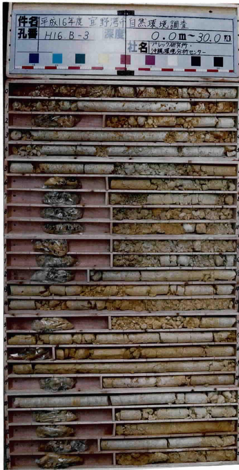
資料 図 1- 6 ボーリングコア写真(H16.B-3)その1
