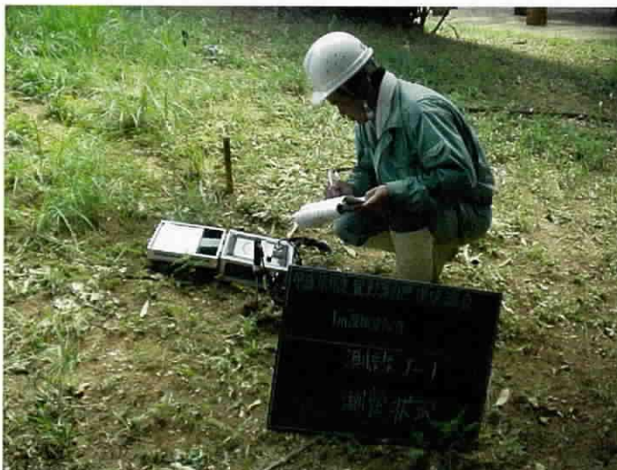
資料 図 1- 10(4) 1m 深地温探査・2次元比抵抗法電気探査現場写真
