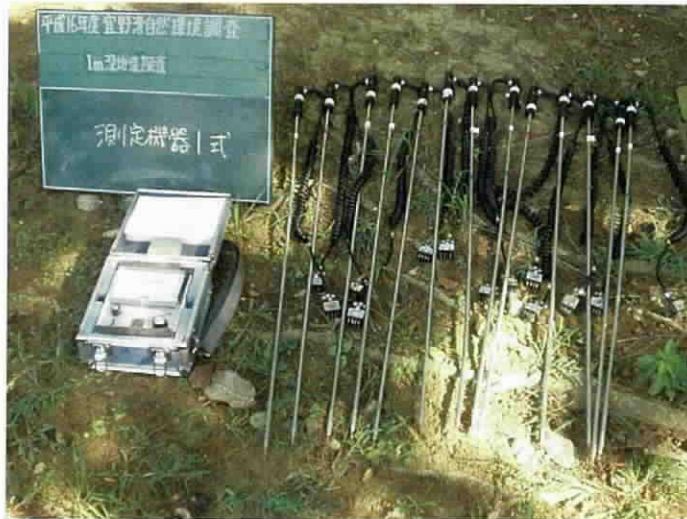
1m 深地温探査 測定機器 1 式
