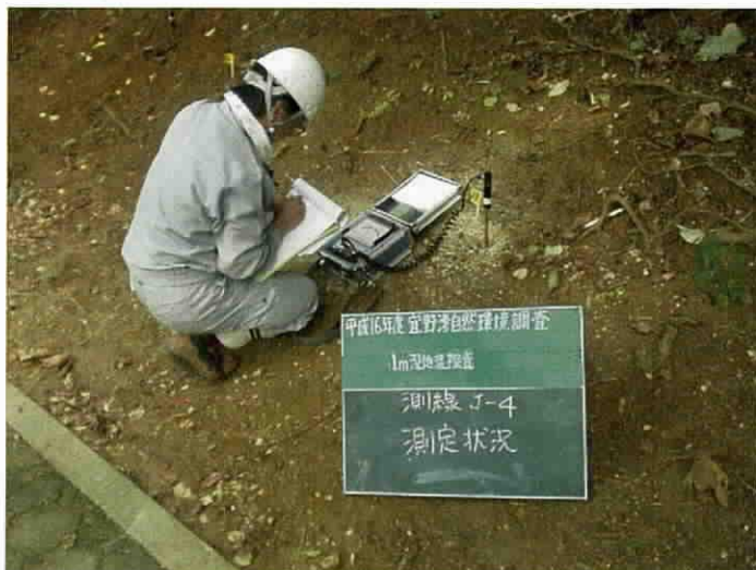
資料 図 1- 10(5) 1m 深地温探査・2次元比抵抗法電気探査現場写真
