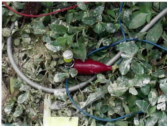
資料 図 1- 10(8) 1m 深地温探査・2次元比抵抗法電気探査現場写真
