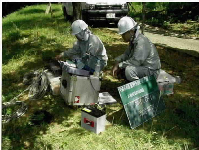
資料 図 1- 10(7) 1m 深地温探査・2 次元比抵抗法電気探査現場写真
