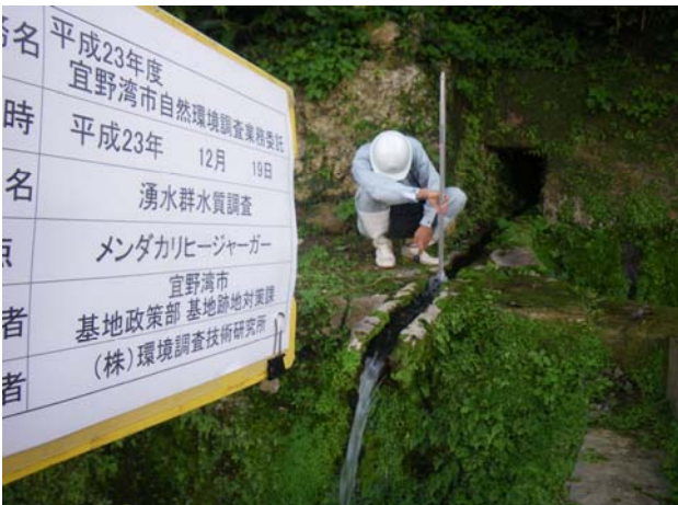
2011/12/19 湧水群水質調査(12月) メンダカリヒージャーガー 流速測定
