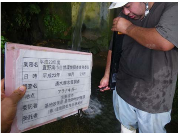
2011/10/21 湧水群水質調査(10月) アラナキガー 透視度の確認
