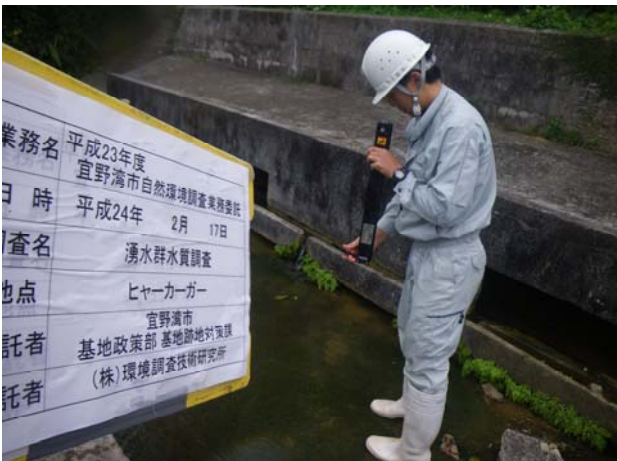
2012/2/17 湧水群水質調査(2月) ヒヤーカーガー 透視度の確認
