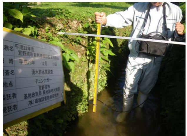
2011/12/19 湧水群水質調査(12月) チュンナガー 流速測定
