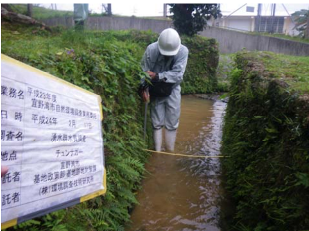
2012/2/17 湧水群水質調査(2月) チュンナガー 流速測定
