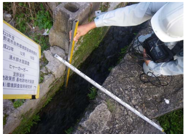
2011/12/19 湧水群水質調査(12月) ヒャーカーガー 流速測定
