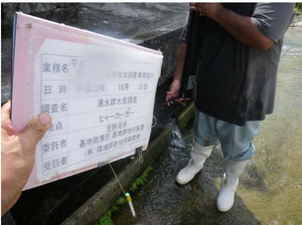
2011/10/21 湧水群水質調査(10月) ヒヤーカーガー 透視度の確認
