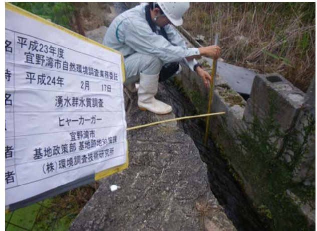
2012/2/17 湧水群水質調査(2月) ヒヤーカーガー 流速測定
