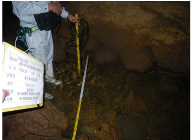
2011/12/19 湧水群水質調査(12月) フルチンガー 流速測定
