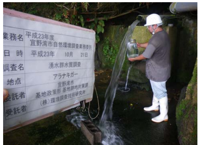
2011/10/21 湧水群水質調査(10月) アラナキガー 採水状況
