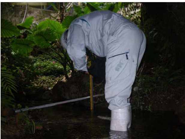
2012/2/17 湧水群水質調査(2月) アラナキガー 流速測定
