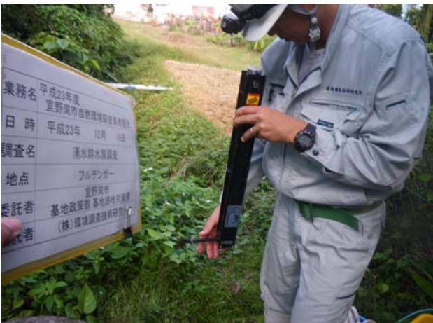
2011/12/19 湧水群水質調査(12月) フルチンガー 透視度の確認
