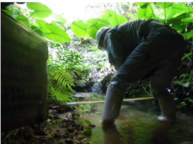
2011/12/19 湧水群水質調査(12月) アラナキガー 流速測定
