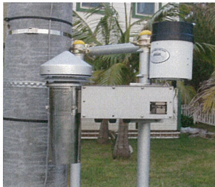
図 2-2-2 気温・湿度計、雨量計の設置イメージ
