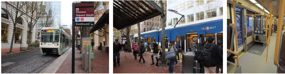
LRT - 歩道を駅として活用しており、車内には自転車を収納するスペースが確保されている
