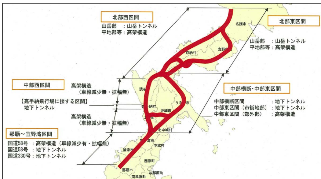
図-48 複数ルートの想定構造(出典:沖縄鉄軌道技術検討委員会資料)
