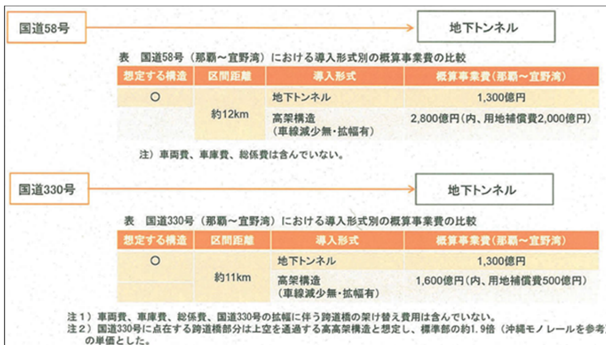
図-53 想定される構造に関する概算事業費の比較(出典:沖縄鉄軌道技術検討委員会資料)
