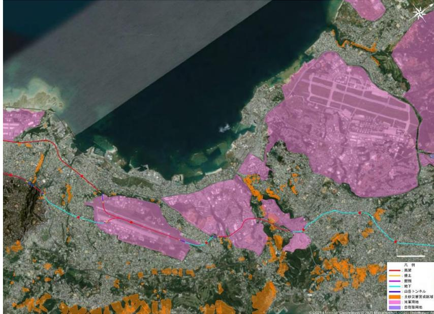
図IV-2 土砂災害警戒区域等を重ね合わせた線路平面図（その2）
