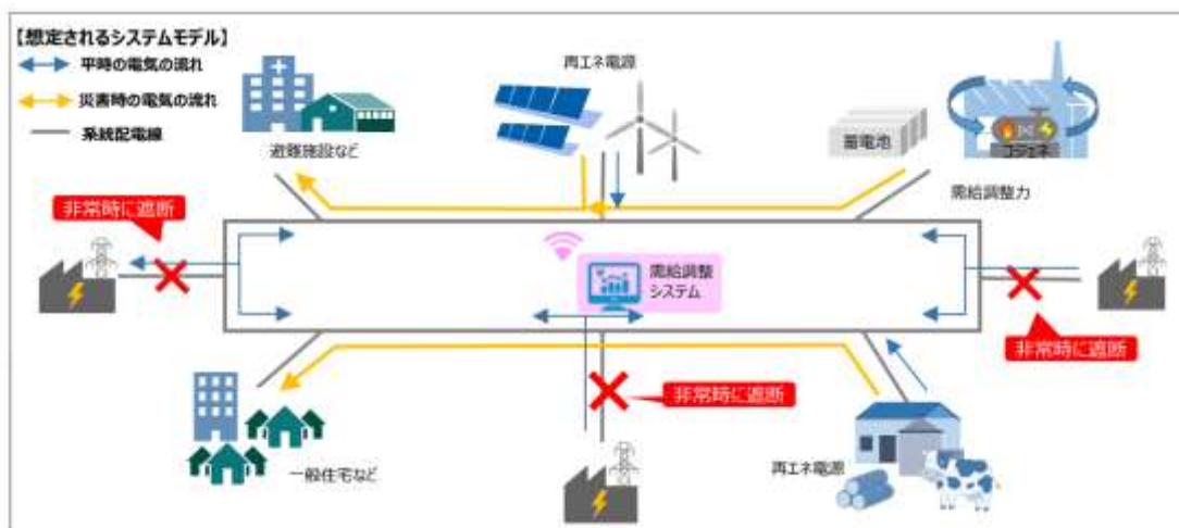
図Ⅱ-5-12 マイクログリッドのシステムモデル
