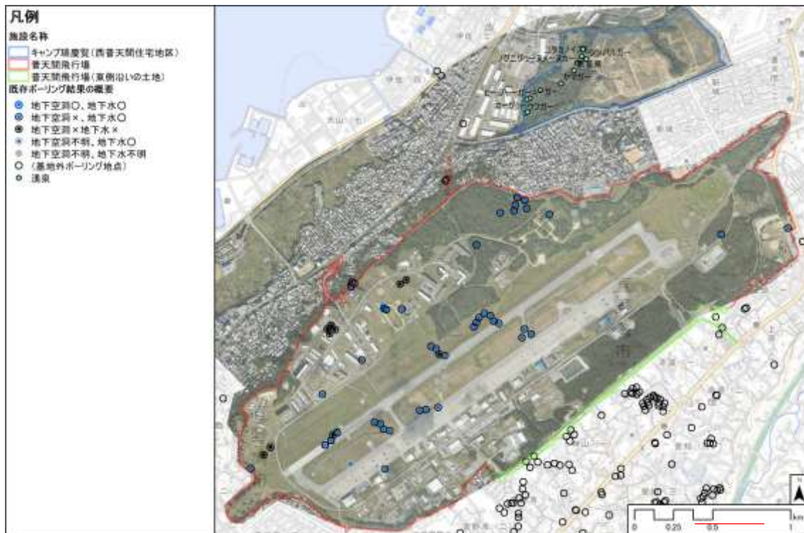
図Ⅱ-4-1 既存ボーリング調査時における普天間飛行場内の地下空洞及び地下水の確認状況
