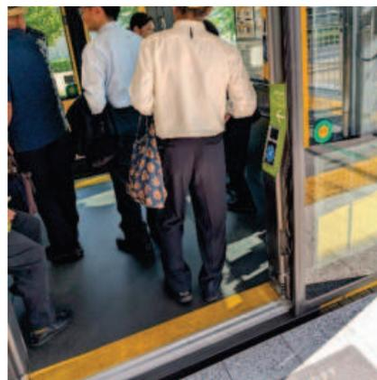
写真：宇都宮LRTの乗降口。入口や車両の繋ぎ目などに段差がない
