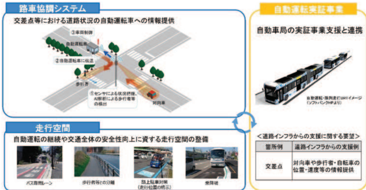
図Ⅲ-2-3 一般道の自動運転移動サービスに求められるインフラ支援
