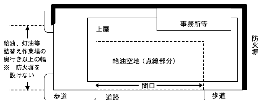
二方開放の屋内給油取扱所の例
