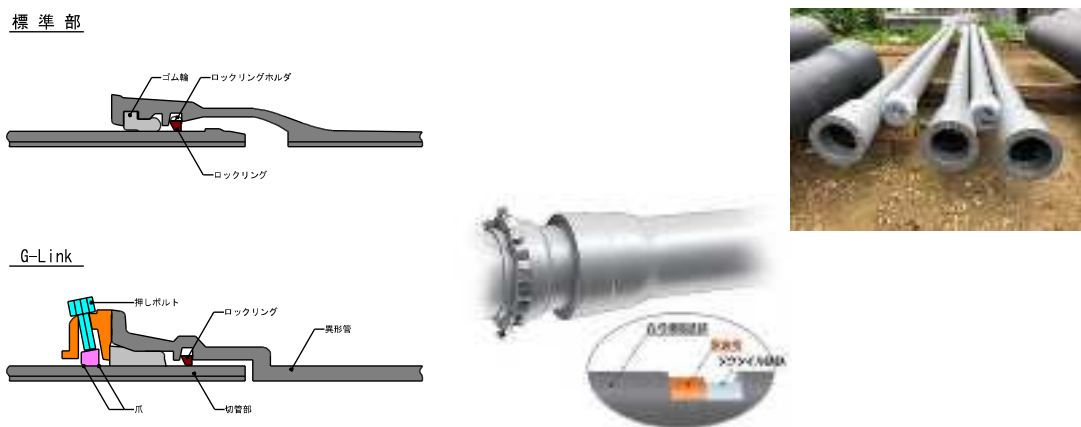
図 2.4.2 GX 形ダクタイル鋳鉄管
