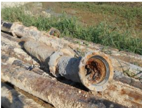
写 2.2.1 老朽化した配水管
