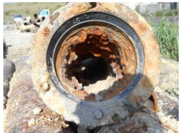
写 2.2.1 老朽化した配水管
