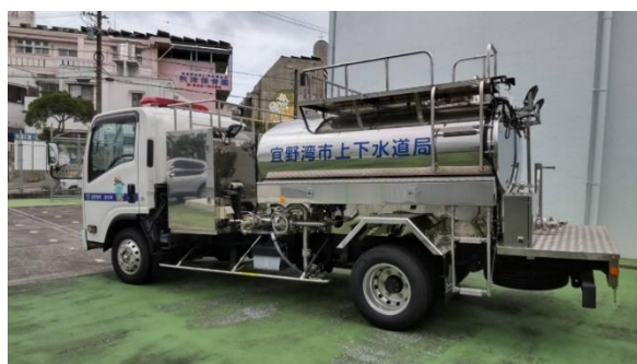
車両一体型給水タンク車【3.0 t(m 3 )】
